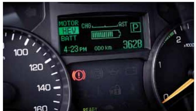
Der Akku-Ladezustand kann im Cockpit abgelesen werden. Die Reichweite der in Stuttgart eingesetzten E-Fahrzeuge beträgt rund 100 km.
