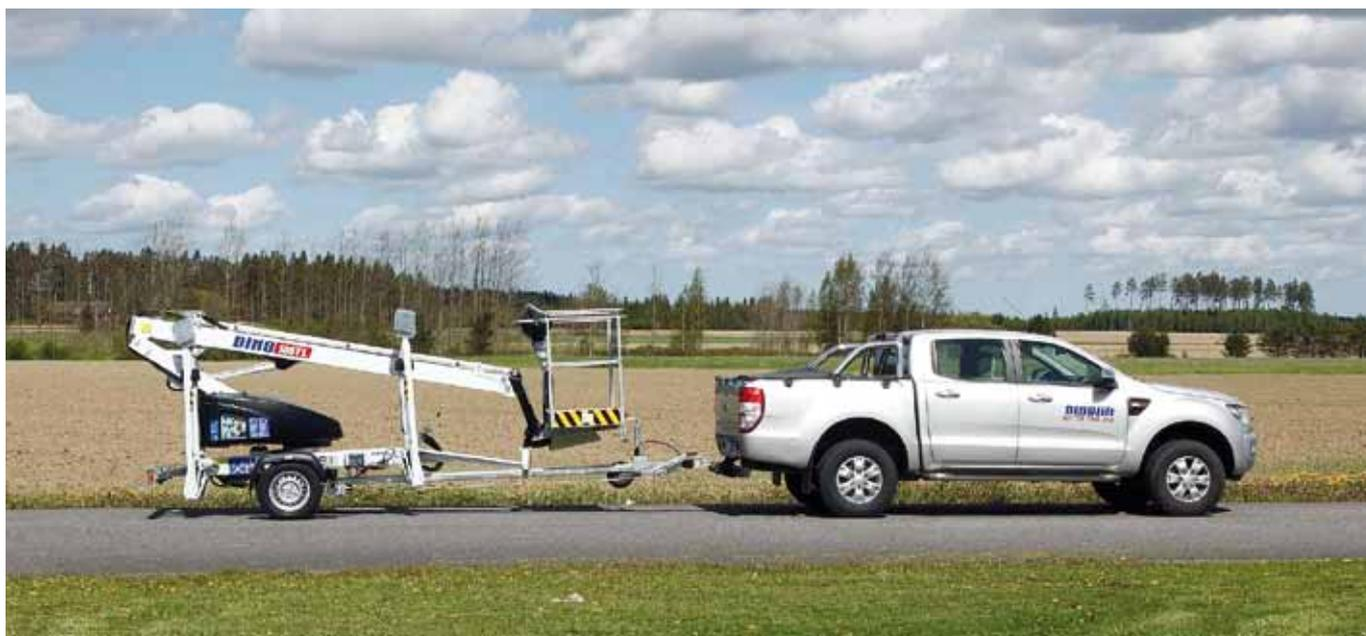
Die Hubarbeitsbühne DINO 105TL von Dinolift weist ein Eigengewicht von lediglich 950 kg auf und darf schon mit dem Führerschein der Klasse B befördert werden. Fotos: Hematec
