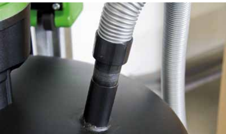
Am FloorMix 2300 und TwinMix 1800 können handelsübliche Industriesauger angeschlossen werden. Fotos: Eibenstock
