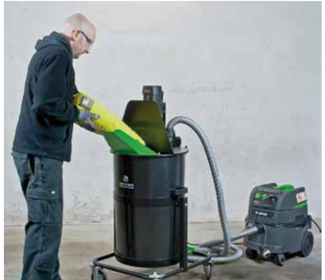
Sackware kann bei beiden EIBENSTOCK-Produktneuheiten, dem FloorMix 2300 (Foto) und dem TwinMix 1800, schnell und staubarm eingefüllt werden.
