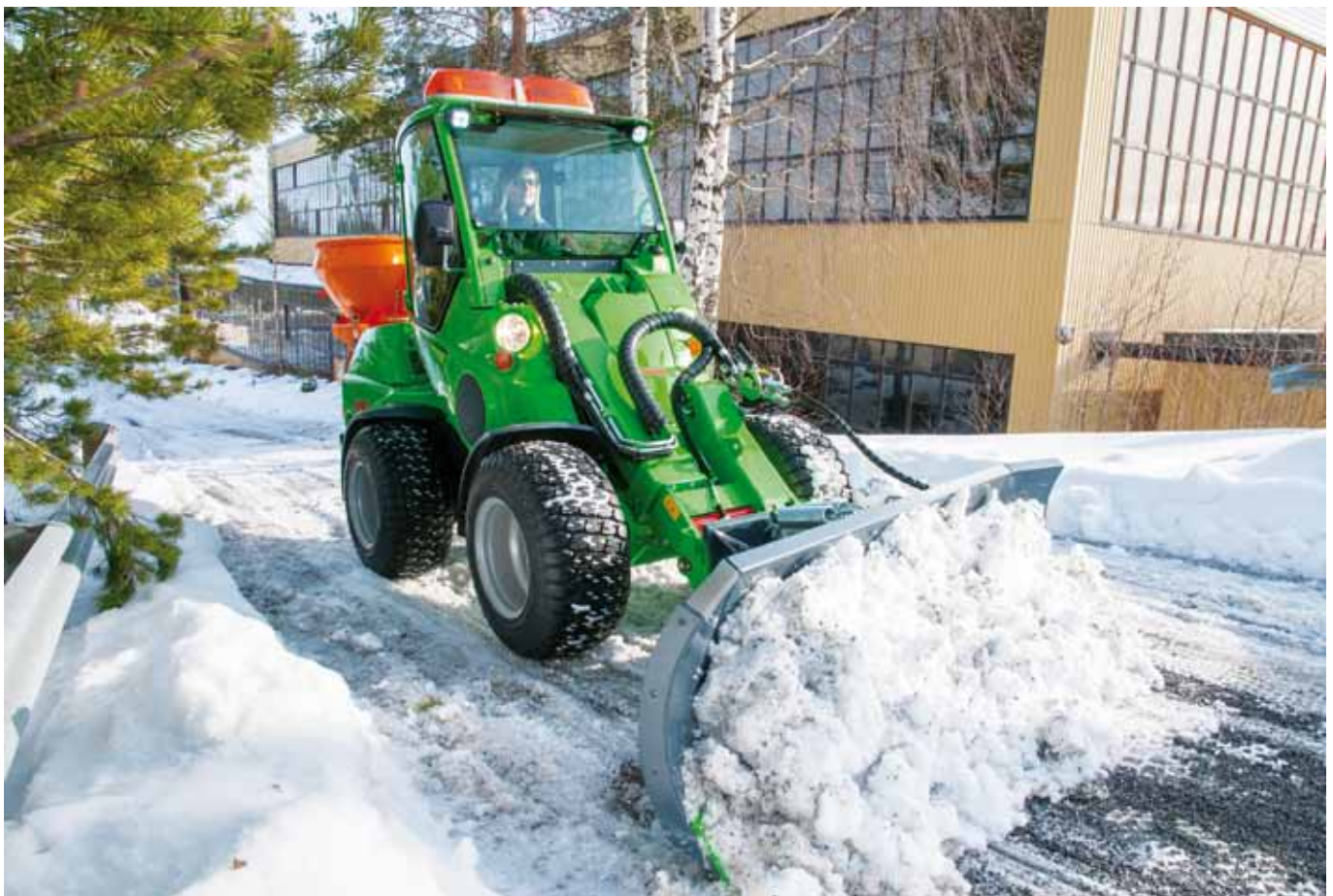
Vorne räumen, hinten streuen: Multifunktionslader mit passenden Anbaugeräten sind ideal für den effektiven Einsatz bei Eis und Schnee.
