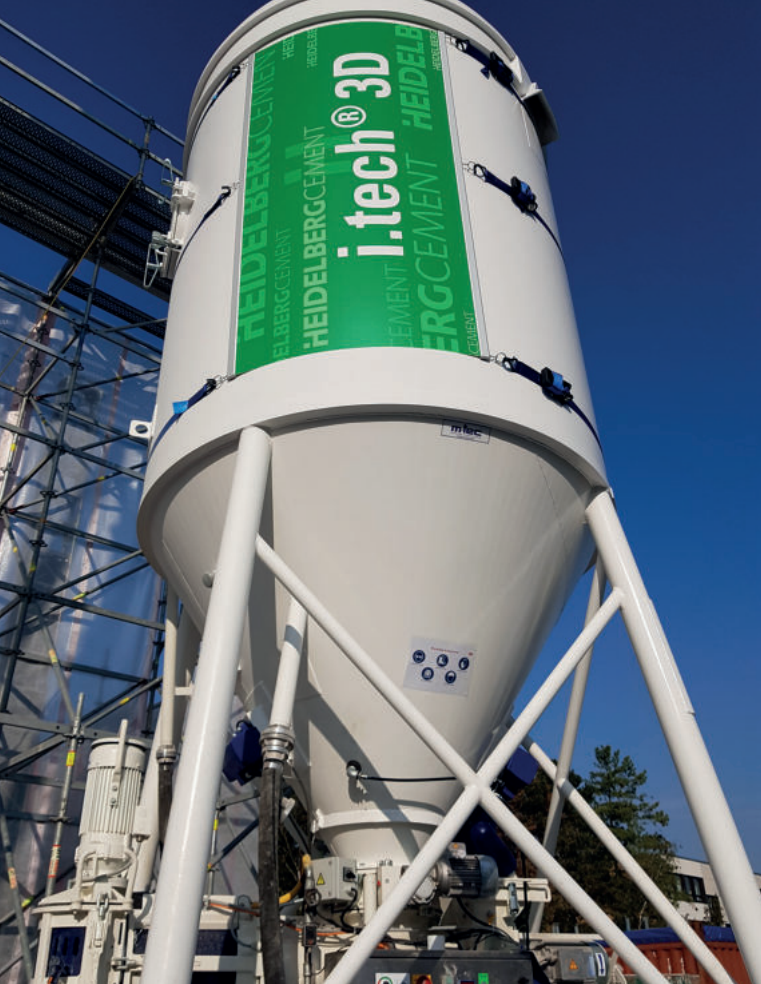
Das neuartige Material „i.tech 3D“ wurde speziell für den Betondruck entwickelt. Foto: HeidelbergCement AG/Dr. Jennifer Scheydt
