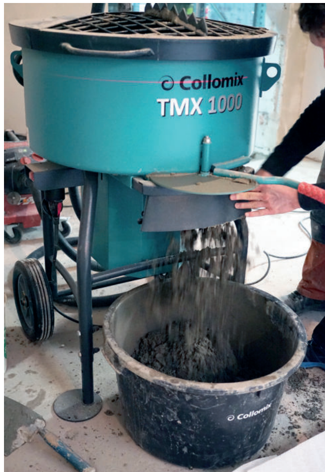
Nach nur 90 s kann die Mischung über den Bodenschieber in den Transporteimer entleert werden.
