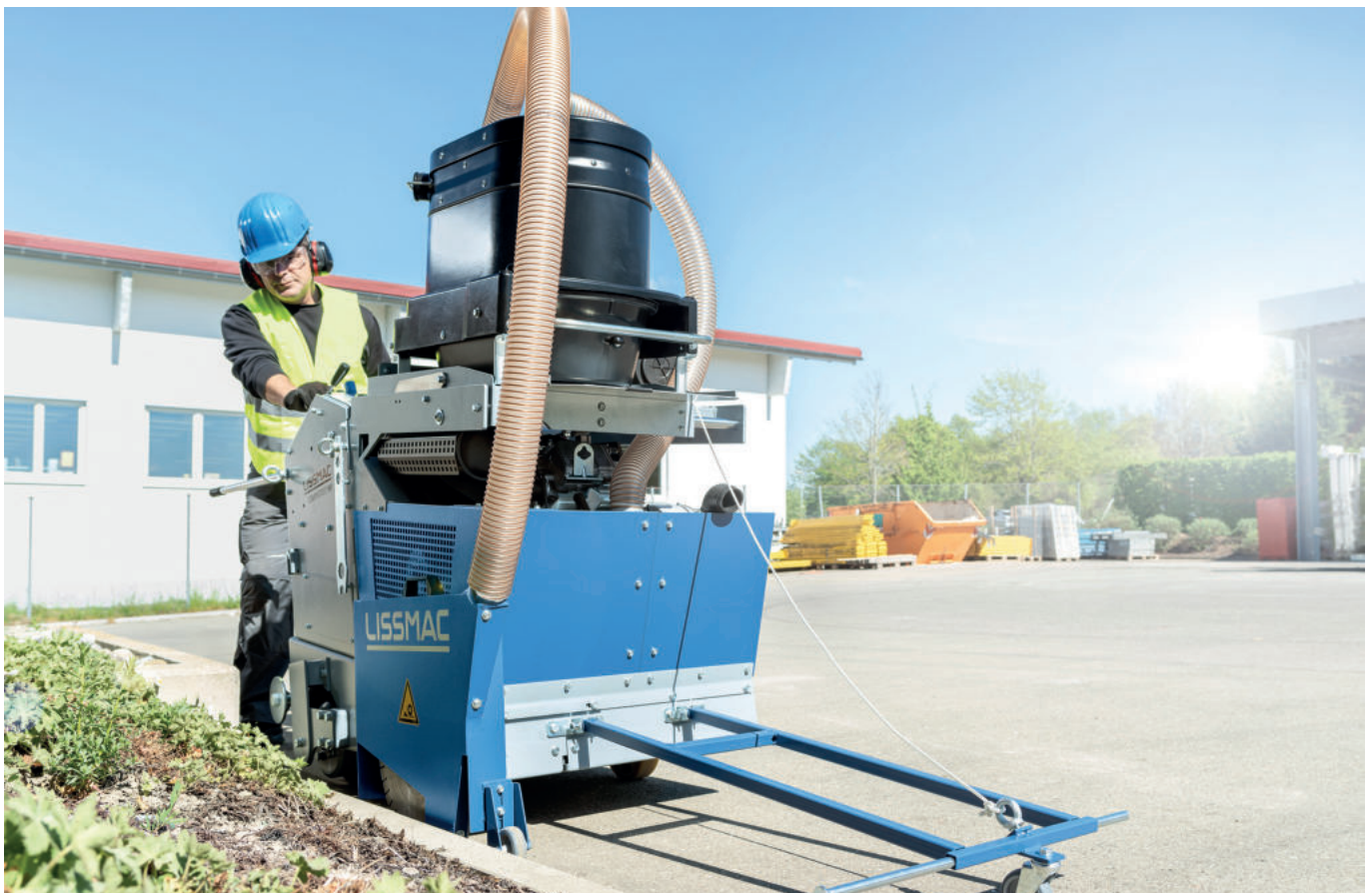
Der COMPACTCUT 900 P/T von LISSMAC ist eine Spezialausführung für das Erstellen von Fugen im Trockenschnittverfahren. In nur einem Arbeitsschritt entstehen vergussfertige Fugen mit einer Tiefe von bis zu 125 mm. Foto: LISSMAC
