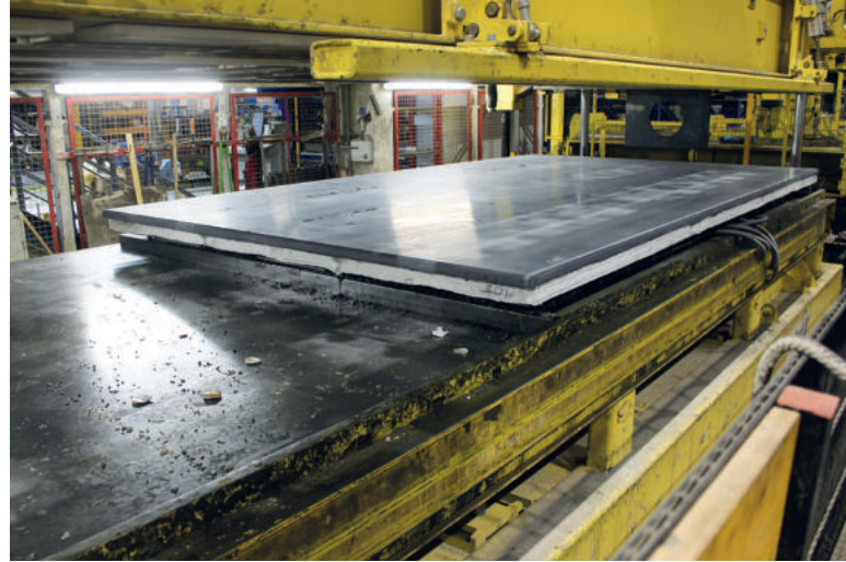
Die nur 27 cm dicken Wandelemente werden im Betonwerk Oschatz hergestellt. Foto: Mario Stelzmann/HTWK Leipzig
