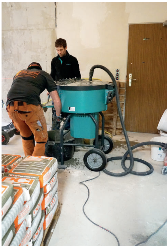
Der TMX 1000 von Collomix verfügt über einen zusätzlichen Anschluss für die Staubabsaugung. Fotos: Collomix
