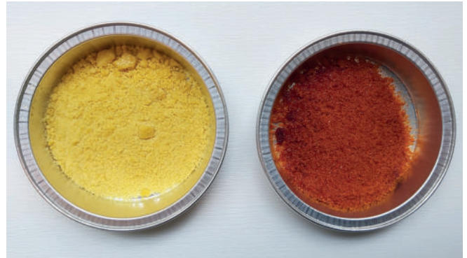
Die neuartige Biopaste besteht aus Lignin (im Bild in unterschiedlichen Bleichegraden zu sehen) sowie Zellulose und ist vollständig abbaubar. Fotos: Mehmet Talha Yapa, Universität Freiburg
