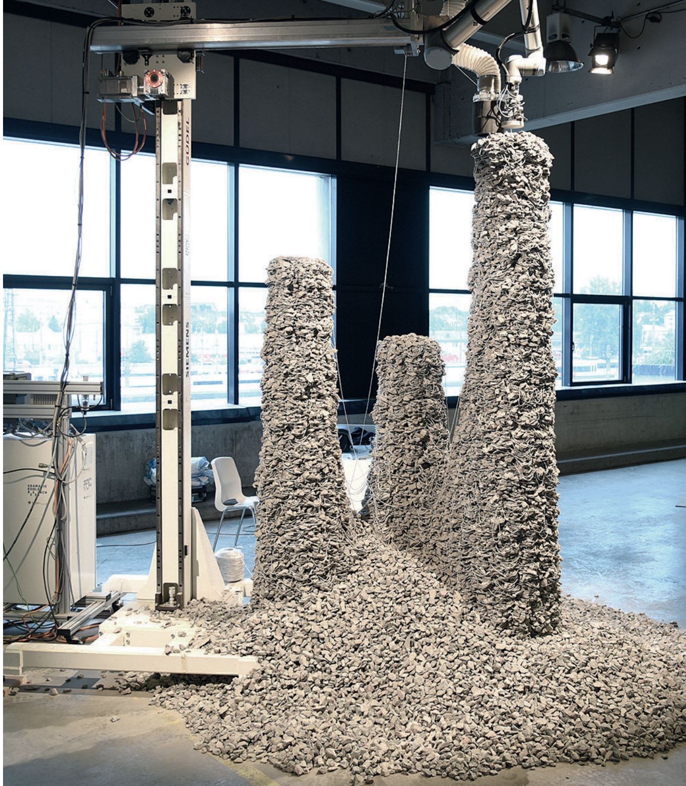
Beim Projekt „Design and Robotic Fabrication of Jammed Architectural Structures“ (2015-2020) von Gramazio Kohler Research wurden mithilfe eines Roboters Säulen aus Schotter und Bindfaden errichtet. Foto: Gramazio Kohler Research, ETH Zürich
