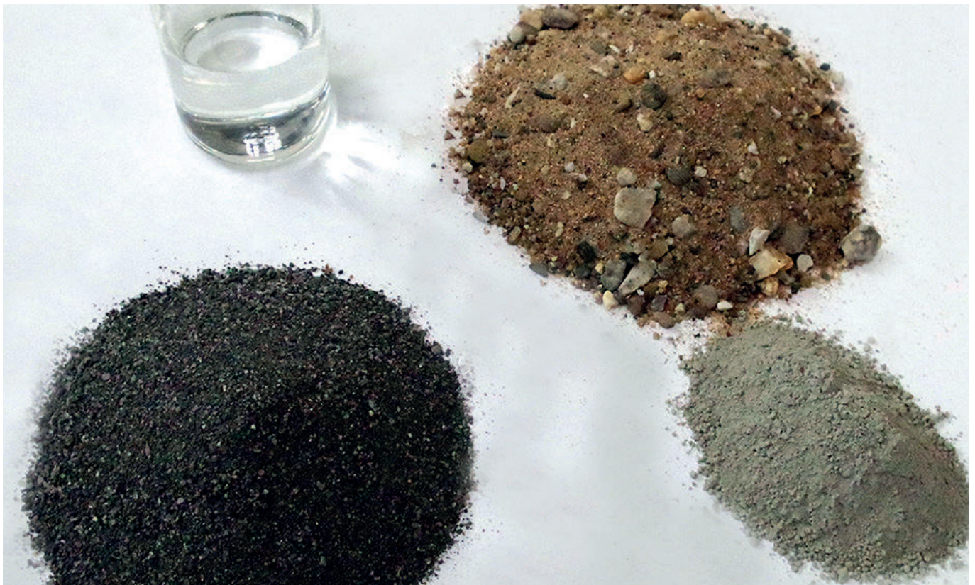
Transportbeton und Betonwerkstein könnten künftig aus Wasser, Müllverbrennungsreststoffen (unten links), Gesteinskörnung (oben rechts) und Zement (unten rechts) hergestellt werden. Foto: TH Köln
