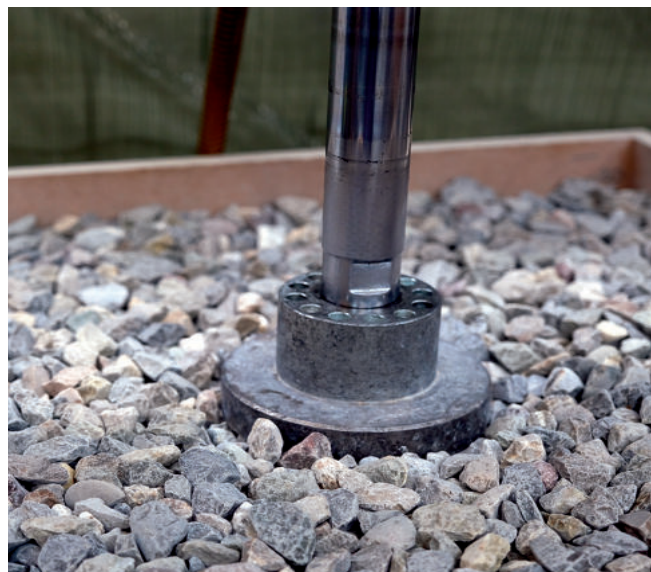
Die Lagen aus Schotter und Bindfaden werden mit einer rotierenden Platte belastet, die hohen Druck auf das Konstrukt ausübt.
