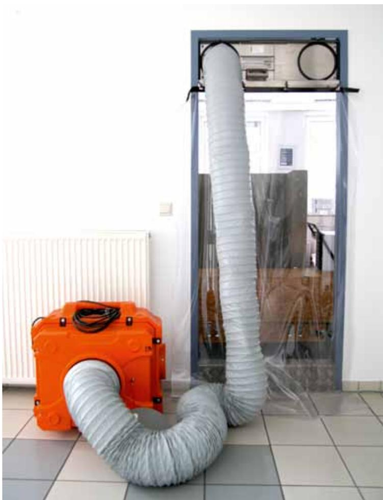
↑ Das Staubschutz-Komplettsystem mit Luftreiniger FT 500 dient der Abschottung und Luftreinigung. Fotos: HEYLO
