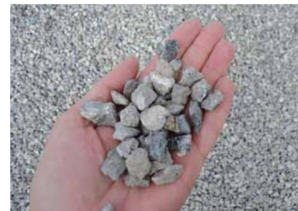
↑ Bei RC-Beton werden natürliche Gesteinskörnungen zu bestimmten Anteilen durch recyceltes Material, wie beispielsweise Altbeton, ersetzt. Foto: CEMEX Deutschland AG
